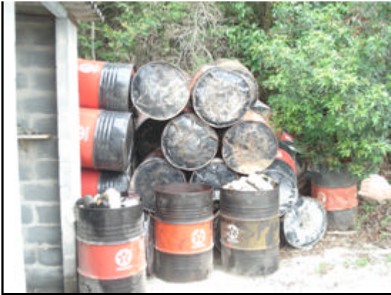
Foto 19. Acondicionamento inadequado de resíduos oleosos.
