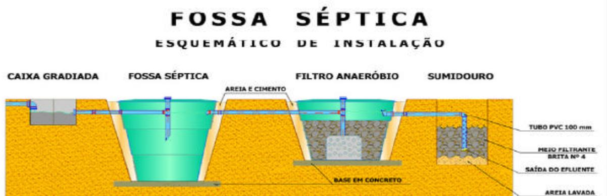
Figura 06 – Desenho esquemático de instalação da Fossa Séptica
