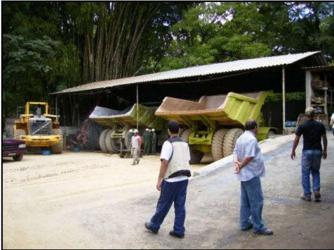
**Foto 09.** Pátio de manutenção de veículos, máquinas e equipamentos com piso concretado e caixa separadora.
