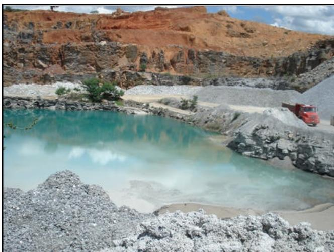
**Foto 03.** Vista de produtos e SUMP para armazenamento de água pluvial dentro da frente de lavra.
