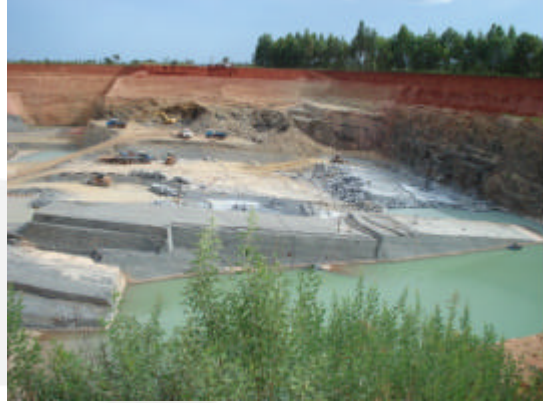
Foto 02. Vista da cava e de sump em 1º plano para reutilização de água em circuito fechado.
