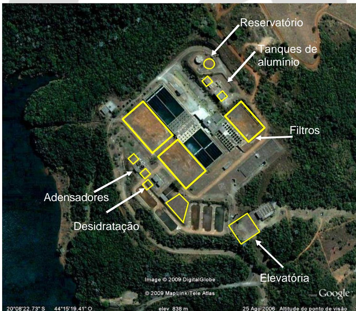
Figura 1: Vista geral da área da ETA com delimitação das áreas destinadas à ampliação
