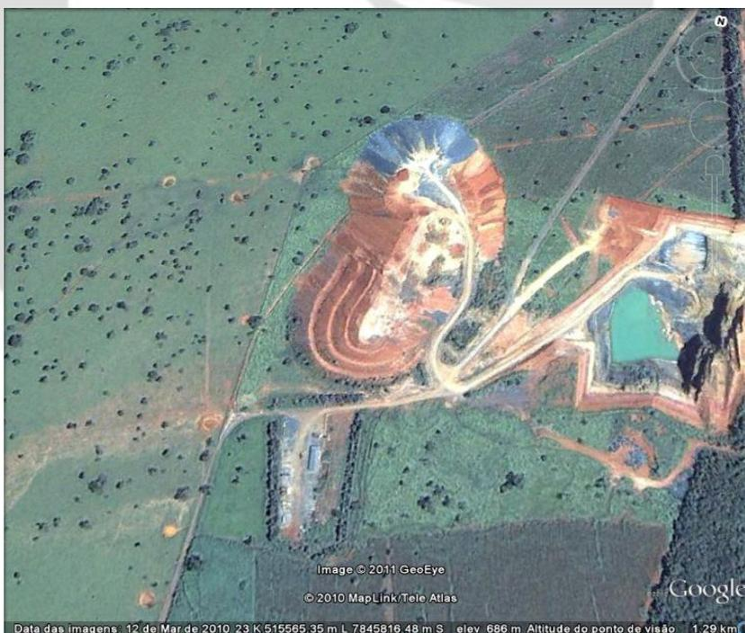
**Imagem 02.** Detalhe do empreendimento mineral: via de acesso, instalações, PDE e frente de lavra.
