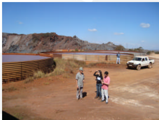
Foto 12. Sistema de recirculação de água utilizada no processo de beneficiamento.
