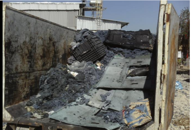
Foto 06. Caçamba de armazenamento de pós de fibras coletadas pelo filtro de manga com resíduos diversos estocados juntos.
