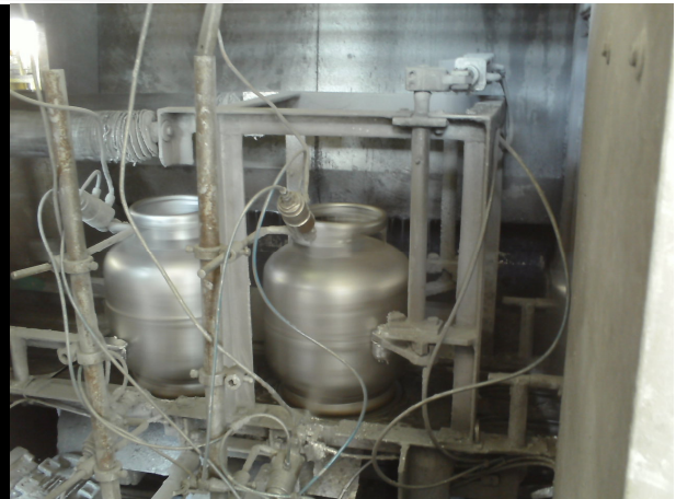
Foto 02. Pintura dos botijões.
