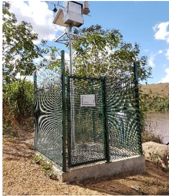
Ponto (RDO 05) – Localizado no Rio Doce em local impactado pelo rejeito (Estação Tipo II, com sonda de qualidade de água instalada em catamarã, e sensor de nível por pressão)
