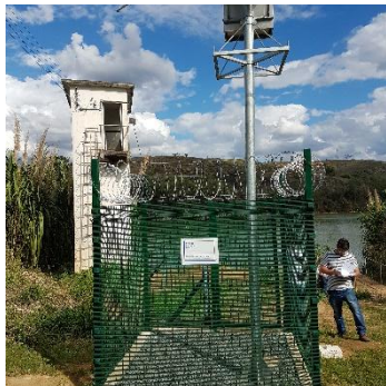
Ponto (RDO 12) – Localizado no Rio Doce a jusante da UHE Mascarenhas e a montante de Colatina/ES em local impactado pelo rejeito (Estação Tipo II, com sonda de qualidade de água, e sensor de nível por pressão)
