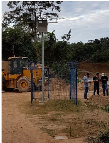
Ponto (RDO 03) – Localizado no Rio Doce em local impactado pelo rejeito (Estação Tipo II, com sonda de qualidade de água instalada em catamarã, e sensor de nível por pressão)
