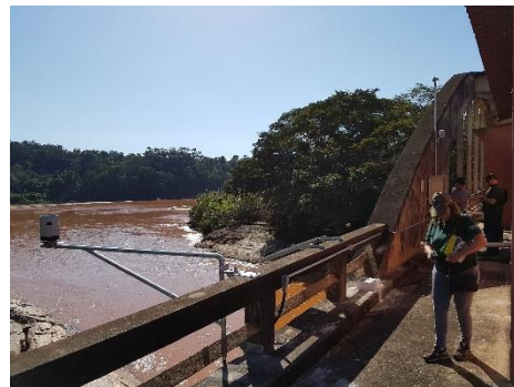
Ponto (RDO 04) – Localizado no Rio Doce (Ponte Escondida) em local impactado pelo rejeito (Estação Tipo II, com sonda de qualidade de água instalada em catamarã, e sensor de nível radar)
