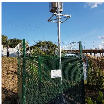
Ponto (RDO 08) – Localizado no Rio Doce (ETA em Governador Valadares) em local impactado pelo rejeito (Estação Tipo II, com sonda de qualidade de água instalada em flutuante, e sensor de nível por pressão)
