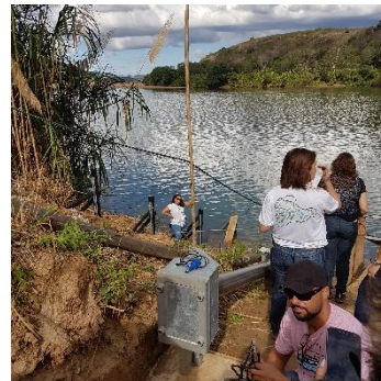
Ponto (RDO 12) – Localizado no Rio Doce a jusante da UHE Mascarenhas e a montante de Colatina/ES em local impactado pelo rejeito (Estação Tipo II, com sonda de qualidade de água, e sensor de nível por pressão)
