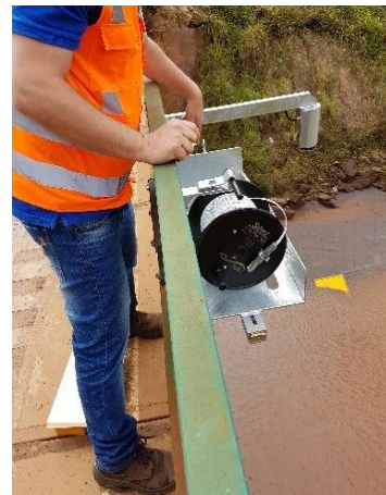
Ponto RGN 06 – Localizado no Rio Gualaxo do Norte em local impactado pelo rejeito (Estação Tipo I, com sensor de turbidez e sensor de nível radar)
