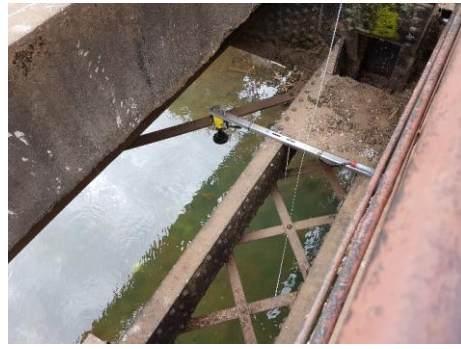
Ponto (RMA 01) – Localizado no Rio Matipó em local não impactado pelo rejeito (Estação Tipo I, com sensor de nível radar)
