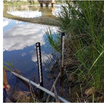
Ponto (RDO 11) – Localizado no Rio Doce em local impactado pelo rejeito (Estação Tipo I com sensor de nível por pressão)
