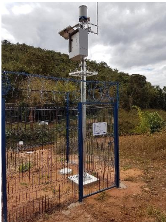
Ponto RGN 06 – Localizado no Rio Gualaxo do Norte em local impactado pelo rejeito (Estação Tipo I, com sensor de turbidez e sensor de nível radar)
