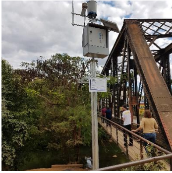
Ponto (RMA 01) – Localizado no Rio Matipó em local não impactado pelo rejeito (Estação Tipo I, com sensor de nível radar)
