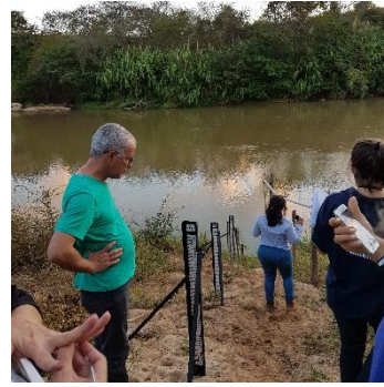
Ponto (RSG 01) – Localizado no Rio Suaçu Grande em local não impactado pelo rejeito (Estação Tipo I com sensor de nível por pressão)
