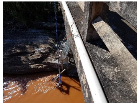
Ponto (RDO 03) – Localizado no Rio Doce em local impactado pelo rejeito (Estação Tipo II, com sonda de qualidade de água instalada em catamarã, e sensor de nível por pressão)
