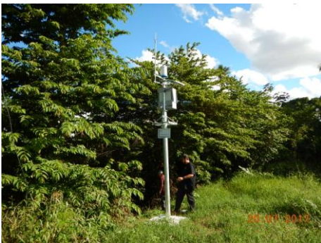
Ponto (RDO 14) – Localizado no Rio Doce, a jusante de Colatina/ES, em local impactado pelo rejeito (Estação Tipo I com sensor de nível por pressão)
