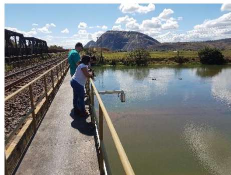
Ponto (RMH 01) – Localizado no Rio Manhuaçu em local não impactado pelo rejeito (Estação Tipo I com sensor de nível radar)
