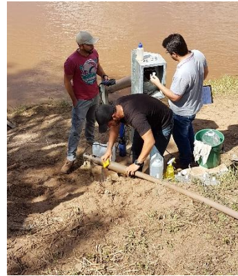
Ponto (RDO 05) – Localizado no Rio Doce em local impactado pelo rejeito (Estação Tipo II, com sonda de qualidade de água instalada em catamarã, e sensor de nível por pressão)
