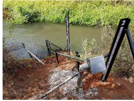
Ponto RGN 01 – Localizado no Rio Gualaxo do Norte em local não impactado pelo rejeito (Estação Tipo I, com sensor de turbidez e sensor de nível por pressão)
