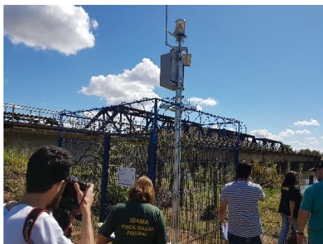
Ponto (RMH 01) – Localizado no Rio Manhuaçu em local não impactado pelo rejeito (Estação Tipo I com sensor de nível radar)
