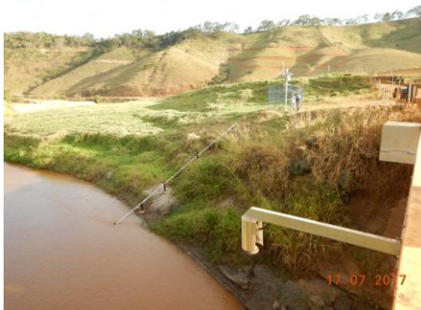
Ponto (RGN 08) – Localizado no Rio Gualaxo do Norte em local impactado pelo rejeito (Estação Tipo I, com sensor de turbidez e sensor de nível radar)
