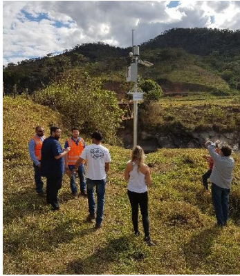
Ponto RCA 01 – Localizado no Rio do Carmo em local não impactado pelo rejeito (Estação Tipo I, com sensor de turbidez e sensor de nível radar)
