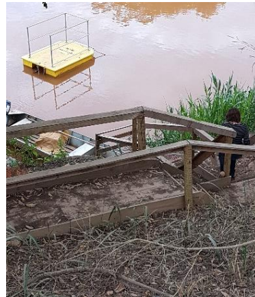
Ponto (RDO 03) – Localizado no Rio Doce em local impactado pelo rejeito (Estação Tipo II, com sonda de qualidade de água instalada em catamarã, e sensor de nível por pressão)
