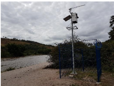
Ponto (RDO 01) – Localizado no Rio Doce, a montante da UHE Candonga, em local impactado pelo rejeito (Estação Tipo II, com sonda de qualidade de água e sensor de nível por pressão)
