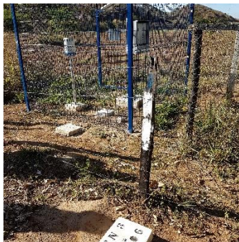
Ponto (RDO 07) – Localizado no Rio Doce em local impactado pelo rejeito, à jusante da UHE Baguarí (Estação Tipo I com sensor de nível por pressão)
