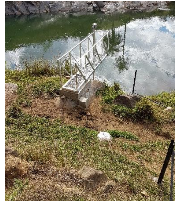
Ponto RCA 01 – Localizado no Rio do Carmo em local não impactado pelo rejeito (Estação Tipo I, com sensor de turbidez e sensor de nível radar)
