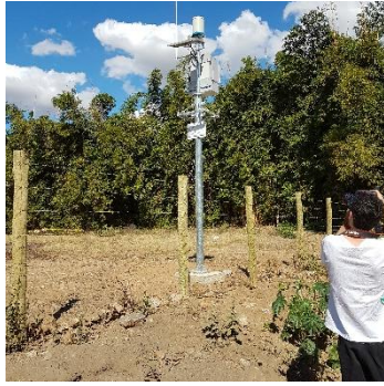
Ponto (RDO 11) – Localizado no Rio Doce em local impactado pelo rejeito (Estação Tipo I com sensor de nível por pressão)
