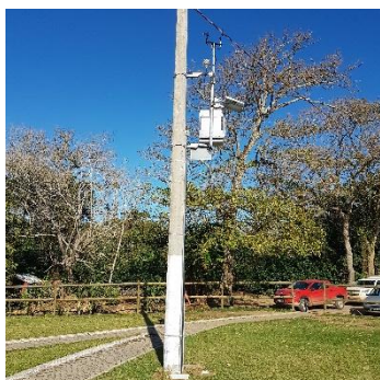
Ponto (RDO 15) – Localizado no Rio Doce, em Regência/ES, em local impactado pelo rejeito (Estação Tipo I com sensor de nível radar e sensor de direção e velocidade do vento)
