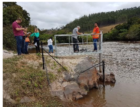
Ponto (RDO 01) – Localizado no Rio Doce, a montante da UHE Candonga, em local impactado pelo rejeito (Estação Tipo II, com sonda de qualidade de água e sensor de nível por pressão)
