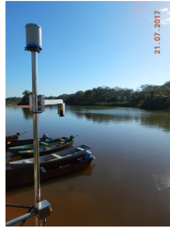
Ponto (RDO 16) – Localizado no Rio Doce, Em Regência/ES, no porto, em local impactado pelo rejeito (Estação Tipo I com sensor de nível radar e sensor de turbidez)
