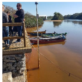
Ponto (RDO 15) – Localizado no Rio Doce, em Regência/ES, em local impactado pelo rejeito (Estação Tipo I com sensor de nível radar e sensor de direção e velocidade do vento)
