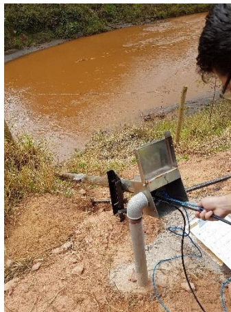
Ponto RGN 06 – Localizado no Rio Gualaxo do Norte em local impactado pelo rejeito (Estação Tipo I, com sensor de turbidez e sensor de nível radar)
