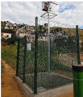
Ponto RCA 02 – Localizado no Rio do Carmo em local impactado pelo rejeito (Estação Tipo II, com sonda de qualidade de água e sensor de nível por pressão)
