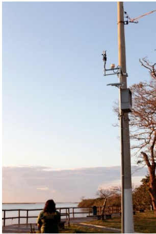
Ponto (RDO 16) – Localizado no Rio Doce, Em Regência/ES, no porto, em local impactado pelo rejeito (Estação Tipo I com sensor de nível radar e sensor de turbidez)
