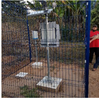
Ponto (RSG 01) – Localizado no Rio Suaçu Grande em local não impactado pelo rejeito (Estação Tipo I com sensor de nível por pressão)
