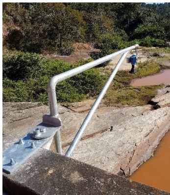
Ponto (RDO 04) – Localizado no Rio Doce (Ponte Escondida) em local impactado pelo rejeito (Estação Tipo II, com sonda de qualidade de água instalada em catamarã, e sensor de nível radar)
