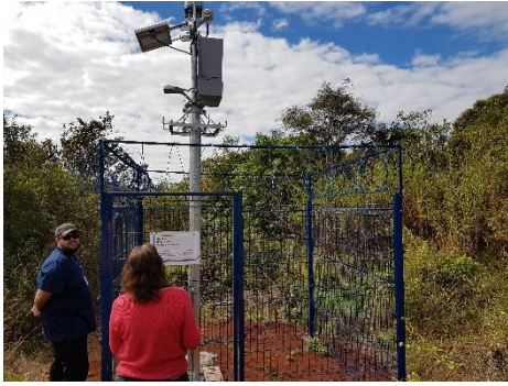
Ponto RGN 01 – Localizado no Rio Gualaxo do Norte em local não impactado pelo rejeito (Estação Tipo I, com sensor de turbidez e sensor de nível por pressão)
