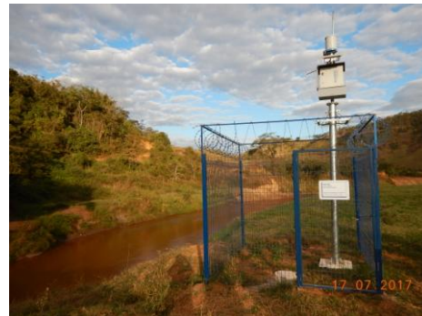
Ponto (RGN 08) – Localizado no Rio Gualaxo do Norte em local impactado pelo rejeito (Estação Tipo I, com sensor de turbidez e sensor de nível radar)
