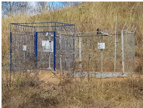
Ponto (RDO 09) – Localizado no Rio Doce em local impactado pelo rejeito (Estação Tipo I com sensor de nível por pressão)
