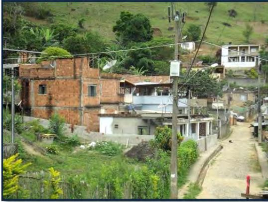
Foto 17 - Interior da ocupação irregular na encosta. Não há um sistema de drenagem adequado, o que agrava a situação de risco.
