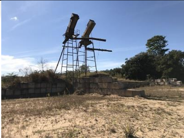
Foto 05: Vista do porto de areia 1 e “peneirões”, localizados no Sítio Santo Antônio.
