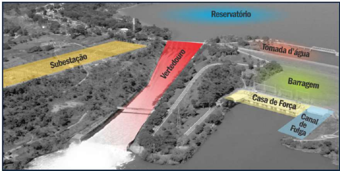
FIGURA 4 - Fluxograma de operação da UHE Três Marias
