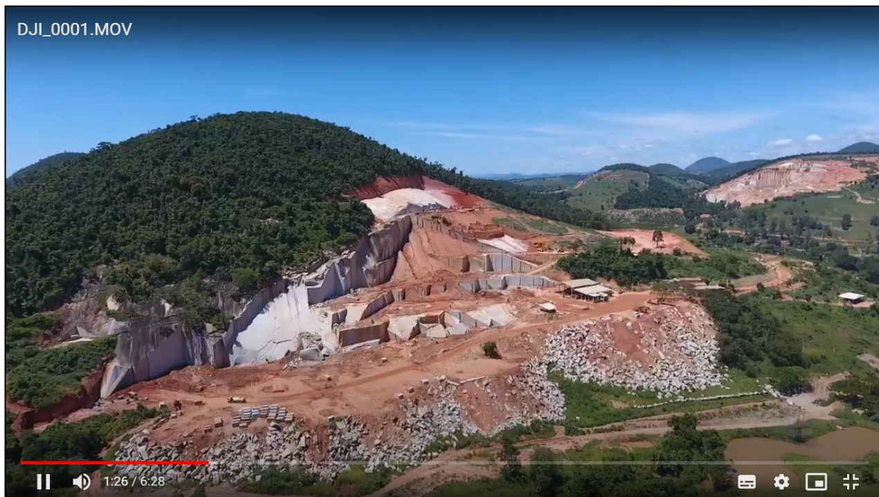
Foto 01. Vista geral do empreendimento Mineração São Sebastião. Em primeiro plano, observa-se a pilha de rejeito/estéril, frente de lavra atual e infraestrutura de apoio. Na base da pilha há dique de contenção de blocos não comercializáveis. Aos fundos, nota-se a presença de outro empreendimento minerário.
