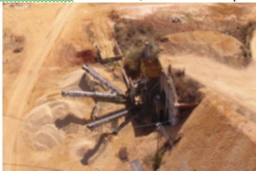
Classificadora de seixo rolado, e suas correias transportadoras
