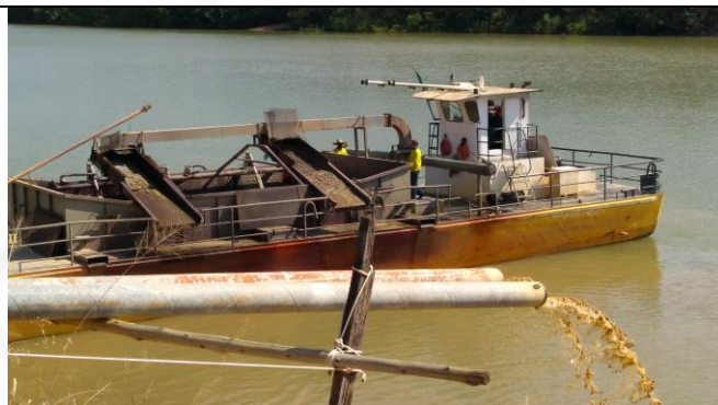
Foto 4. Embarcação utilizada na realização de dragagem.
