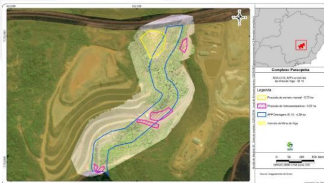
Figura 3.8: Áreas a serem recuperadas na APP do córrego Angu próximo a Pilha Top soil. Nesse ponto está previsto plantio de mudas, semeio manual, hidrossemeadura e biomanta. Fonte: Programa de Recuperação de APPs. Fonte: Vale, 2022.
