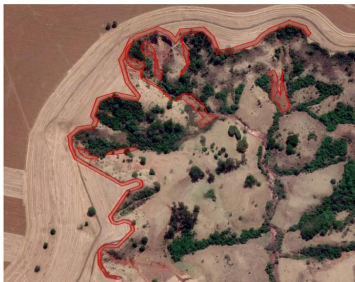
**FIGURA 5.** Áreas onde serão feitos os plantios de mudas de espécies nativas, para controle da erosão, conforme PTRF apresentado. Coordenadas geográficas de um ponto de referência (cordão de eucalipto): 20°3'27.61" S. e 47°13'18.98" W.
