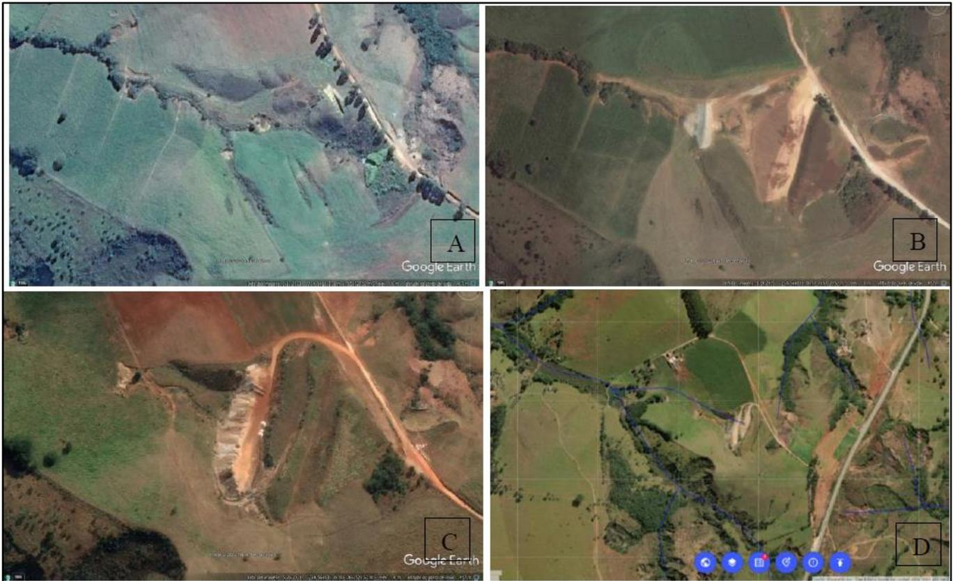
**Imagem 4:** Imagens obtidas pelo Google Earth Pro, ilustrando a área de deposição de estéril nas datas de: A – 13/05/2013; B – 14/01/2015; C - 26/05/2021. Em D, imagem obtida na IDE-Sisema demonstrando a drenagem no local de implantação do aterro.
