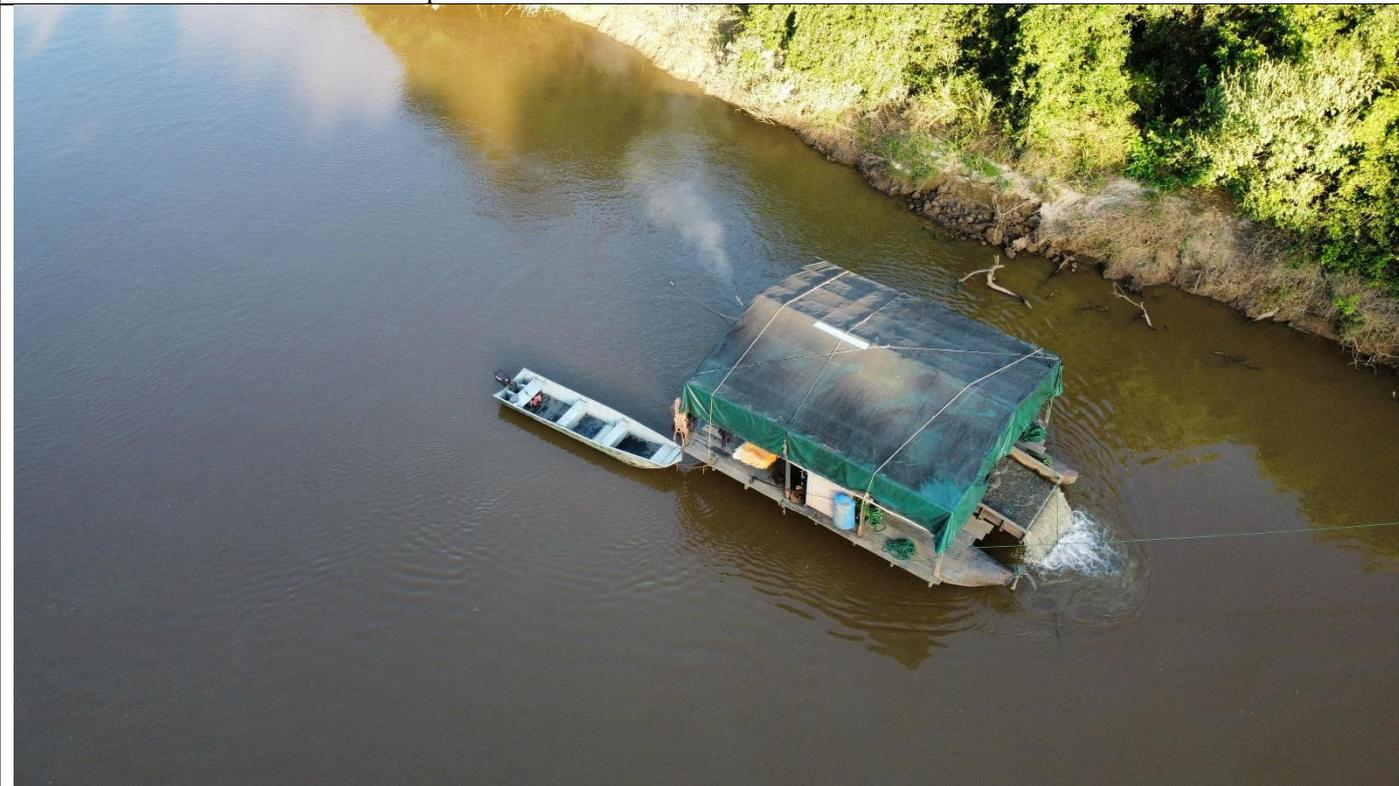
Foto aérea tirada por meio de drone, onde se vê a draga em operação e ainda se nota que a atividade é pontual, não há intervenção em APP e não se verifica na foto a pluma de contaminação pelos sedimentos extraídos na operação de dragagem, o que se pressupõe, apesar de haver necessidade de análises, que os níveis de sólidos sedimentáveis e totais NÃO ESTÃO ACIMA dos limites permitidos na DN COPAM-CERH/MG Nº 8/2022.
